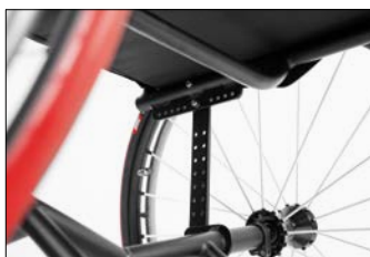
Altezze sedile e COG regolabili Регулируемое сиденье высота и центр тяжести.
