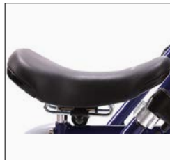
Sella Viscount con supporto regolabile.
