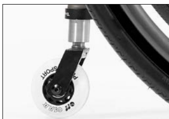
Antiribaltamento regolabile. Регулируемый антипрокидыватель
